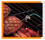
ПРИМЕЧАНИЕ: Когда вы определяете температуру, вы должны зафиксировать зонд зажимом, чтобы получать стабильные показания измерения.
