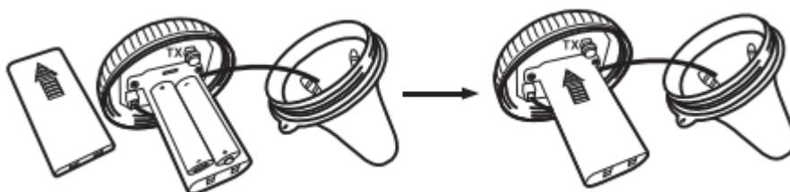
Установите водонепроницаемое кольцо, закройте и затяните аккумуляторный отсек до конца (обязательно затяните кольцо плотно, чтобы избежать попадания воды).
