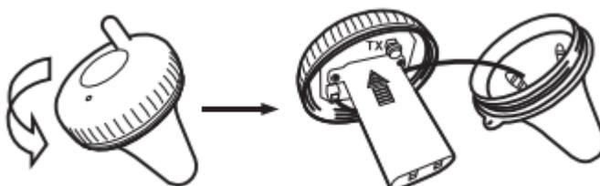
Установите батарейки согласно указанной инструкции и закройте крышку
